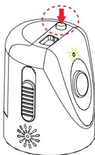
Per mettere in standby o rimuovere il dispositivo, premere e rilasciare il pulsante di accensione in posizione "OFF".
