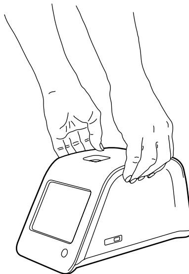
Figura 5 Sollevamento dello strumento con due mani.
