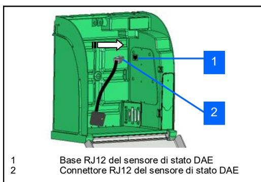
• Il Sensore di stato del DAE si collega alla base e si posa quindi sulla sua base, a sua volta fissata sul DAE.
